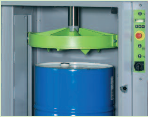
Großer Press-Stempel: Mit Belüftungsdornen und beidseitiger Führung.
